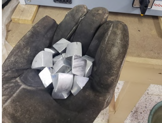
Figura 6: Muestras de la aleación 7075
