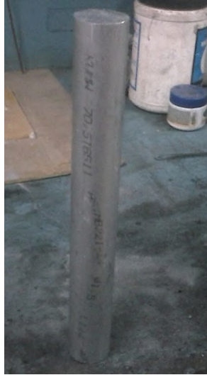
Figura 5: Barra de aleación 7075 (ZICRAL)
