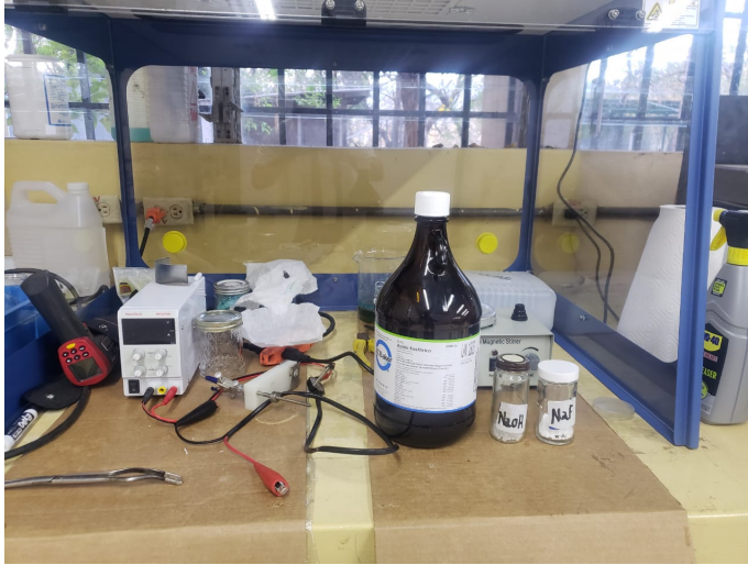
Figura 8: Equipo y ácidos para el electropulido y ataque de muestras
